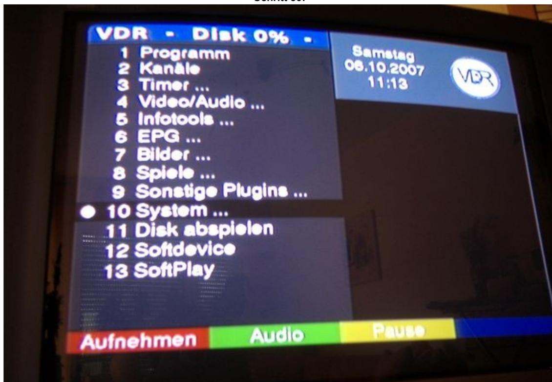
Das System startet nun neu, es wird nun am Anfang nicht länger versucht das „softdevice-dfb“ neu anzulernen. Nun können wir über die Tastatur die Fernbedienung aktivieren. Öffnen Sie das Menü über die Taste „M“ und wählen Sie den Punkt „System“ mit der Eingabetaste aus.
