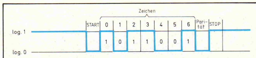
Bild 3. Leitungspegel beim Senden des Zeichens 'M' (hexa 4D, gerade Parität, 1 STOP-Bit)
